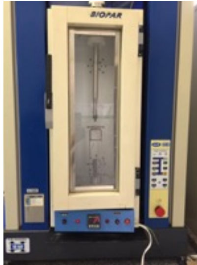
Figura 3. Máquina de Ensaio Universal (EMIC) mais estufa (Biopar) para o teste de três pontos. Fonte: Arquivo Pessoal
